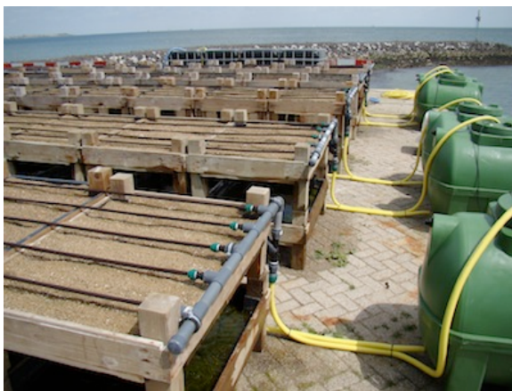
Afbeelding 1. Opstelling van de bakproef: via het voorraadvat (groen) vond irrigatie d.m.v. druppelslangen plaats, waarbij het overtollige water werd opgevangen en teruggeleid naar het voorraadvat.
