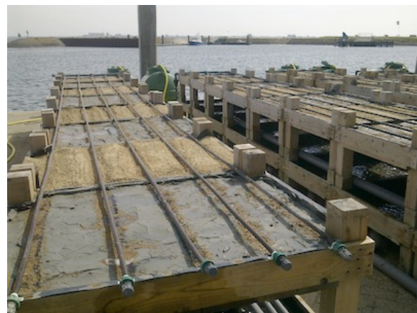
Afbeelding 1. Opstelling van de bakproef: via het voorraadvat (groen) vond irrigatie d.m.v. druppelslangen plaats, waarbij het overtollige water werd opgevangen en teruggeleid naar het voorraadvat.
